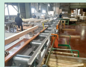
集成材製造ライン(仕上げ工程)
